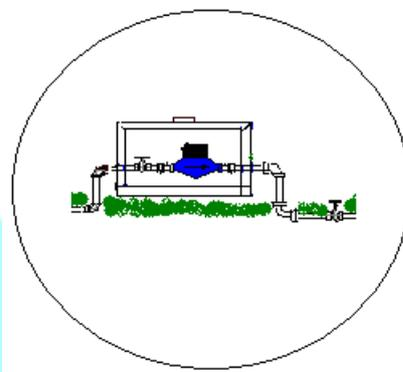
**OBS: Nos casos em que o comprimento do hidrômetro for inferior a 190mm, deve-se usar um tubete longo.**
