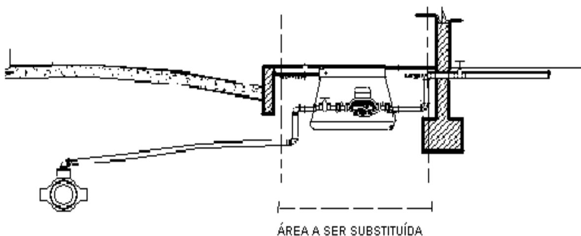
**OBS:** Nos casos em que o comprimento do hidrômetro for inferior a 190mm, deve-se usar um tubete longo.
