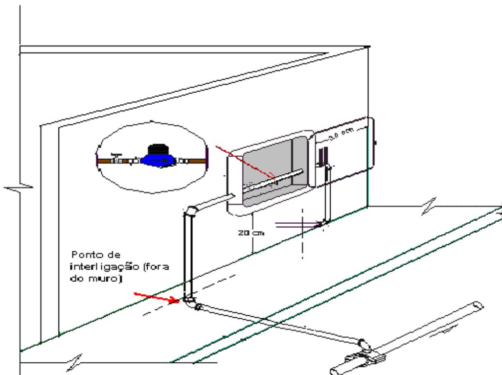
**OBS: Nos casos em que o comprimento do hidrômetro for inferior a 190mm, deve-se usar um tubete longo a ser fornecido pela contratante**
